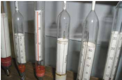
Die Oechslegrade stellte man lange Zeit mit der sogenannten Oechslewaage fest.
