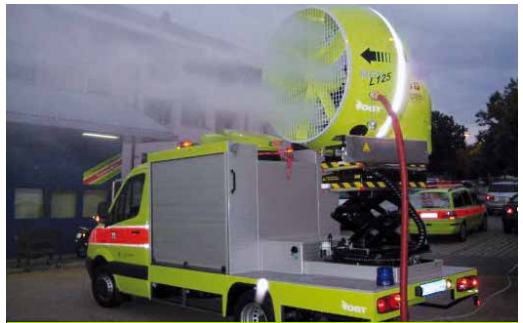
Schwere Mittel für den Kanton: Mobiler Grosslüfter im Einsatz.
